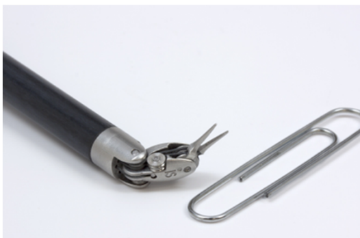
ロボットの鉗子：関節がついており複雑なことが容易にできる
